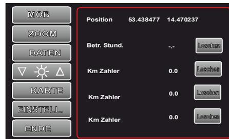
Wenn diese Taste gedrückt wird, erscheint ein Bildschirm mit der aktuellen Position, der Anzahl der gezählten Motorstunden, der zurückgelegten Gesamtstrecke, der aktuell zurückgelegten Strecke und der Gesamtmenge an Kraftstoff, die seit dem Zurücksetzen des Kilometerzählers verbraucht wurde. Diese Parameter können über die Schaltfläche Löschen zurückgesetzt werden.
