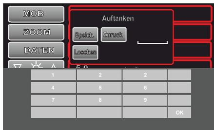
Geben Sie über die Tastatur den richtigen Wert ein und speichern Sie ihn. Die eingegebene Menge wird zu der bereits im Tank befindlichen Menge addiert, sodass die angegebene Kraftstoffmenge erhöht wird.
