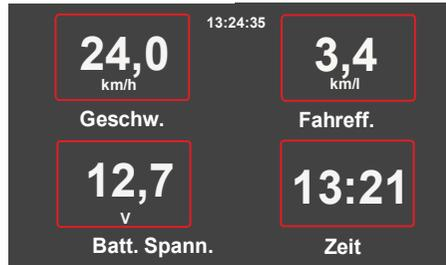
Auf dem Kombibildschirm können Parameter zur besseren Lesbarkeit mit Hilfe der vergrößerten Zeichengröße angezeigt werden. Die anzuzeigenden Parametern werden über die Schaltfläche Einstellungen im Element ZOOM-Einstellungen ausgewählt.
